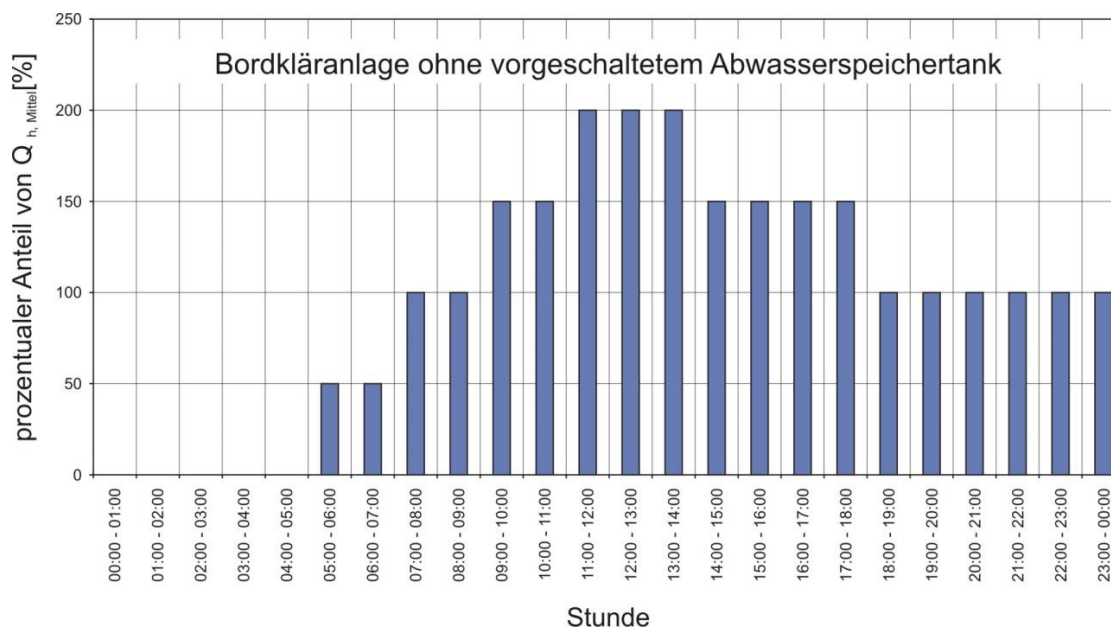
Abbildung 2: Tagesganglinie der Bordkläranlagen-Beschickung ohne vorgeschalteten Abwasserspeichertank
