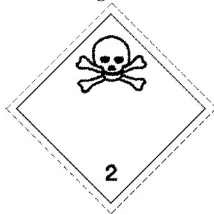
(Nr. 2.3) Giftige Gase Symbol (Totenkopf mit gekreuzten Gebeinen): schwarz auf weißem Grund; Ziffer «2» in der unteren Ecke
