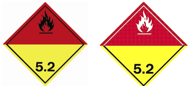
(Nr. 5.2) Symbol (Flamme): schwarz oder weiß auf rotem (obere Häl- fte) und gelbem Grund (untere Häl- fte); Ziffer «5.2» in der unteren Ecke
